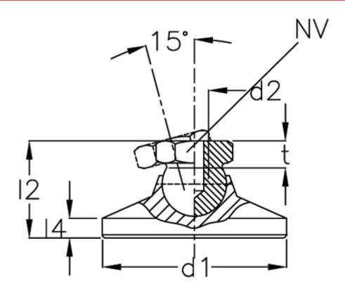
d1 = 50 d2 = 10 l2 = 28 l4 = 7 NV = 15 Static load (kN) = 23 t min = 10.5
